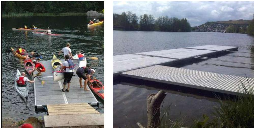
Figura 5. Instalaciones de muelles flotantes modulares de materiales plásticos.
